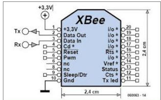
Fig 3: XBEE Module
